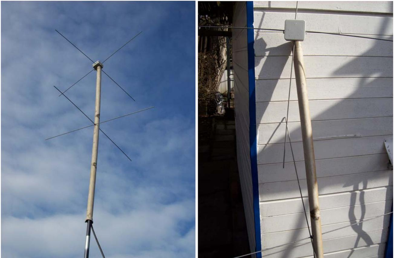
Die Verteilerdose liegt lose oben auf dem Rohr, was Vorteile beim Verstauen und Transport der Antenne bringt (Bild rechts).
