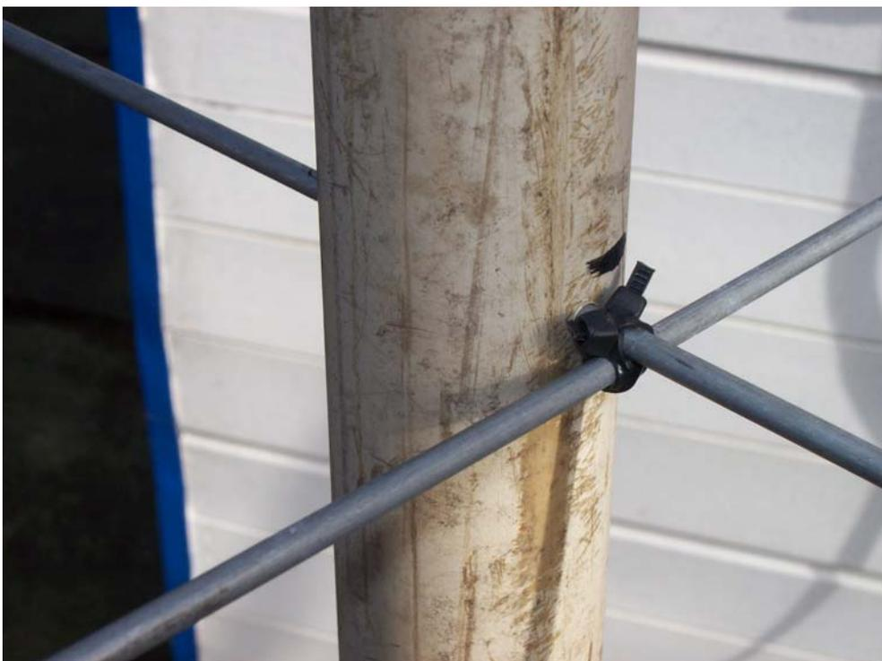
Detail des Reflektors. Die beiden Rundstäbe werden durch zwei über kreuz gebundene Kabelbinder zusammen gehalten. Damit der Reflektor waagrecht steht, muß man den frei hängenden Rundstab genau austarieren ;-)
