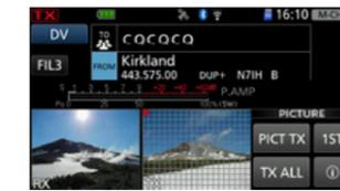
Der IC-705 verfügt über die neuesten Funktionen im DV-Modus. Mit den Terminal-/Access-Point-Modi haben Sie direkten Zugang zum D-STAR-Netzwerk. Zusätzlich kann man über die mit dem IC-9700 eingeführte Share-Pictures-Funktion Bilder zwischen dem IC-705 und dem IC-9700 ohne weitere Hilfsmittel teilen.
