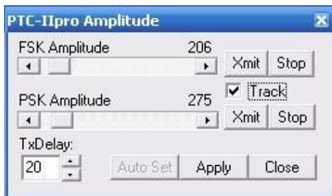
Nun stellt man sicher, dass der Audio-Kompressor am Transceiver ausgeschaltet ist, schaltet das Transceiver Messinstrument auf ALC, klickt auf 'Xmit' im Tool und stellt die Amplitude mit dem Schieber so ein, dass die ALC **minimal** (höchstens ein Teilstrich) wirksam wird. Mit „Apply“ wird diese Einstellung abgespeichert.
