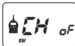
Wenn die DW-Funktion aktiviert ist, werden die beiden Kanäle gleichzeitig überwacht. Zum Senden auf dem Hauptkanal die **[PTT]**-Taste und zum Senden auf dem Zweitkanal die **[MON]**-Taste drücken. Bei aktivierter DW-Funktion dient die **[MON]**-Taste nicht zur Aktivierung der Monitor-Funktion. Zum Ausschalten der DW-Funktion die Bedienschritte wiederholen und OF wählen.
