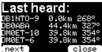
Hier werden die zuletzt empfangenen vier Stationen mit Entfernung in km und Richtung in Grad angezeigt. Bereits empfangene Stationen werden bei erneutem Empfang aktualisiert. Mit „close“ verlassen Sie das Menü sofort. Einträge sind Absteigend sortiert. Der neueste Eintrag steht immer ganz oben.
