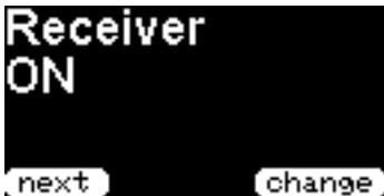
Receiver „ON“ oder „OFF“ schaltet den eingebauten **Empfänger an bzw. aus**. Auch im ausgeschalteten Zustand werden Positionsmeldungen versendet! Der Empfänger wird lediglich für den Empfang von APRS Paketen und persönlichen Nachrichten verwendet. Wenn Sie PicoAPRS als KISS-TNC verwenden, wird der Empfänger automatisch aktiviert.
