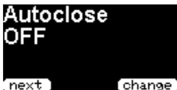
Autoclose schliesst auf dem Hauptbildschirm dargestellte Positions- sowie Statusmeldungen nach der eingestellten Zeit automatisch. Die Positionsmeldungen können dennoch im Menü „**Last heard**“ abgerufen werden. Autoclose kann mit „**OFF**“ deaktiviert bzw. eine Zeit zwischen **10 und 300 Sekunden** eingestellt werden.
