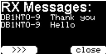
Empfangene Nachrichten. Reihenfolge absteigend (neueste oben). Wenn der Text länger als die darstellbare Breite für den Textbereich ist, wird der Text automatisch durchgeblättert.
