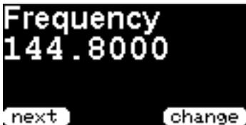
Hier stellen Sie die zu verwendende APRS Sende und Empfangsfrequenz ein. Die Frequenz ist auf die in Europa übliche Frequenz von 144.800 MHz voreingestellt und muss im Normalfall nicht verändert werden.
