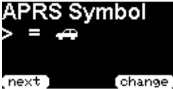
Hier stellen Sie Ihr eigenes APRS Symbol ein welches bei anderen Empfängern angezeigt werden soll. Für die am häufigsten genutzten Symbole wird ein „=“ und das entsprechende Symbol angezeigt und diese befinden sich gleich am „Anfang“, so dass man sehr schnell zwischen z.B. PKW und Fußgänger wechseln kann. Bei allen anderen Symbolen wird ein ASCII Zeichen angezeigt.
