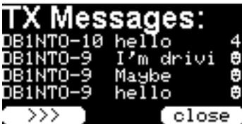
Gesendete Nachrichten. Reihenfolge absteigend (neueste oben). Wenn der Text länger als die darstellbare Breite für den Textbereich ist, wird der Text automatisch durchgeblättert. Ganz rechts wird angezeigt, wie viele Zustellversuche noch übrig sind (Zahl 0-5), bzw. ein Bindestrich dafür, dass kein Zustellbericht empfangen wurde oder ein „smiley“ falls ein Zustellbericht vom Empfänger angekommen ist.
