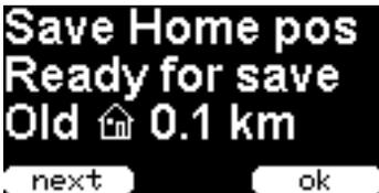
Im Menü „**Save Home pos**“ können Sie Ihre aktuelle Position als „Home“ Position fest im Gerät speichern. Diese wird nach einem Neustart verwendet, wenn keine GPS Position bekannt ist. Wenn Sie als APRS Symbol ein Haus verwenden, wird diese Position auch ohne GPS Empfang zum versenden von Positions Baken verwendet. Falls Sie zuvor eine Position gespeichert haben, wird Ihnen bei vorhandenem GPS
