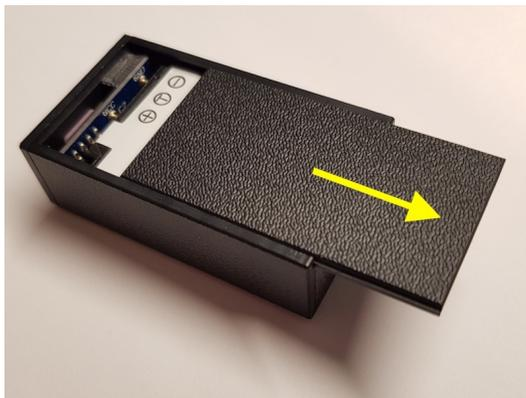
3. Entnehmen Sie den Akku am unteren Ende aus dem Gerät
