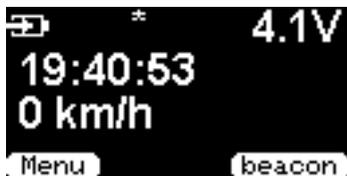
In diesem Beispiel wird der eingebaute Akku gerade aufgeladen. Das **Batteriesymbol mit Pfeil blinkt während dem Ladevorgang.**
