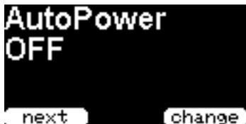
Wenn Sie AutoPower auf „**Power Off**“ einstellen, schaltet sich der PicoAPRS aus sobald die USB Stromversorgung getrennt wird und automatisch wieder ein, wenn die USB Stromversorgung wieder angeschlossen wird. Das funktioniert auch bei den meisten Fahrzeugen mit USB über den Zigarettenanzünder via Zündung.
