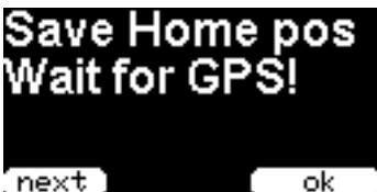
Während der GPS Suche steht in der zweiten Zeile „**Wait for GPS**“. Die Position kann erst mit Druck auf die rechte Taste „**ok**“ abgespeichert werden, wenn in der zweiten Zeile „**Ready for save**“ erscheint.
