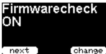
Firmwarecheck prüft ein mal täglich über das APRS Netz ob es ein Firmware Update für Ihren PicoAPRS gibt. Dazu wird eine Nachricht mit dem installierten Firmwarestand an den PicoAPRS Server gesendet. Sofern eine neuere Version verfügbar ist, sendet Ihnen der Server eine Nachricht zurück.
