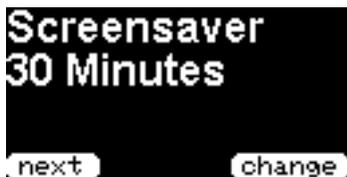
Screensaver schaltet das OLED-Display nach der eingestellten Zeit in Minuten aus, sofern in der eingestellten Zeit keine Taste betätigt wurde. PicoAPRS arbeitet auch mit ausgeschaltetem Display normal weiter. Sobald bei ausgeschaltetem Display eine der beiden Tasten gedrückt wird, wird zuerst das Display wieder aktiviert. Der Tastendruck führt in diesem Fall keine weitere Aktion aus.
