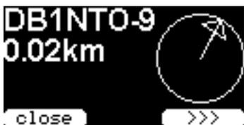
Mit Auswahl von „follow“ wird Ihnen die Entfernung und Richtung IN RELATION zu Ihrer eigenen Fahrtrichtung angezeigt. Wenn Sie sich direkt auf die Station zu bewegen, zeigt der Pfeil geradeaus nach oben. Sollten neue Positionsdaten zu der verfolgten Station empfangen werden, wird diese Darstellung automatisch aktualisiert. Sie können diese Ansicht jederzeit aus dem Menü „GPS data“ wieder
