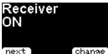
Receiver „ON“ oder „OFF“ schaltet den eingebauten **Empfänger an** bzw. **aus**. Auch im ausgeschalteten Zustand werden Positionsmeldungen versendet! Der Empfänger wird lediglich für den Empfang von APRS Paketen und persönlichen Nachrichten verwendet. Wenn Sie PicoAPRS als KISS-TNC verwenden, wird der Empfänger automatisch aktiviert.
