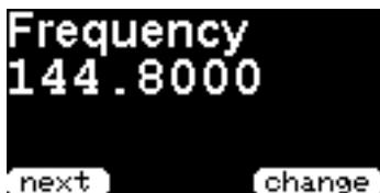
Hier stellen Sie die zu verwendende APRS Sende und Empfangsfrequenz ein. Die Frequenz ist auf die in Europa übliche Frequenz von 144.800 MHz voreingestellt und muss im Normalfall nicht verändert werden.
