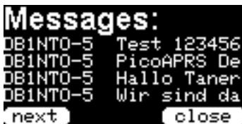
Hier werden die zuletzt empfangenen vier Mitteilungen incl. Absender angezeigt. Der Text wird als **Laufschrift** dargestellt. Doppelt empfangene Mitteilungen werden nur einmal angezeigt. Mit „close“ verlassen Sie das Menü sofort.
