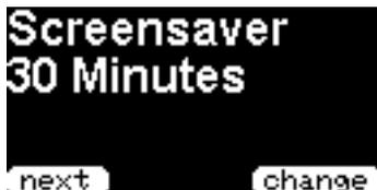
Screensaver schaltet das OLED-Display nach der eingestellten Zeit in Minuten aus, sofern in der eingestellten Zeit keine Taste betätigt wurde. PicoAPRS arbeitet auch mit ausgeschaltetem Display normal weiter. Sobald bei ausgeschaltetem Display eine der beiden Tasten gedrückt wird, wird zuerst das Display wieder aktiviert. Der Tastendruck führt in diesem Fall keine weitere Aktion aus.
