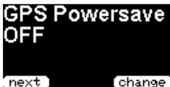
„**GPS Powersave**“ definiert, ob der GPS Empfänger automatisch ausgeschaltet werden soll wenn GPS gerade nicht benötigt wird.
