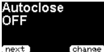
Autoclose schliesst auf dem Hauptbildschirm dargestellte Positions- sowie Statusmeldungen nach der eingestellten Zeit automatisch. Die Positionsmeldungen können dennoch im Menü „**Last heard**“ abgerufen werden. Autoclose kann mit „**OFF**“ deaktiviert bzw. eine Zeit zwischen **10 und 300 Sekunden** eingestellt werden.
