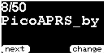
In der ersten Zeile wird Ihnen angezeigt, welche Stelle Sie gerade bearbeiten. Im Beispiel links ist das die Stelle **8** von maximal möglichen **50**.
