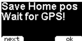
Während der GPS Suche steht in der zweiten Zeile „**Wait for GPS**“. Die Position kann erst mit Druck auf die rechte Taste „**ok**“ abgespeichert werden, wenn in der zweiten Zeile „**Ready for save**“ erscheint.
