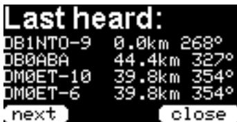
Hier werden die zuletzt empfangenen vier Stationen mit Entfernung in km und Richtung in Grad angezeigt. Bereits empfangene Stationen werden bei erneutem Empfang aktualisiert. Mit „close“ verlassen Sie das Menü sofort.
