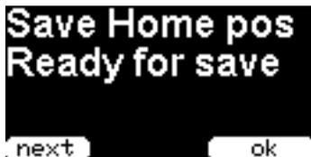
Im Menü „**Save Home pos**“ können Sie Ihre aktuelle Position als „Home“ Position fest im Gerät speichern. Diese wird lediglich für die Darstellung der Entfernungsberechnung von empfangenen APRS Positionsmeldungen verwendet, wenn sonst keine GPS Position bekannt ist (z.B. nach einem Reboot des PicoAPRS).
