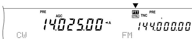
Wenn Sie jedoch weiterhin auf dem MAIN-Band senden möchten, während Sie die Funktionen des Sub-Empfängers einstellen, müssen Sie **[CTRL]** drücken. In dem Fall springt nur das „**CTRL**“-Symbol zum SUB-Display. Das „**PTT**“-Symbol erscheint jedoch weiterhin im MAIN-Display. Diese Einstellung bedeutet, dass Sie auf den VFO-Frequenzen des MAIN-Transceivers senden und empfangen und gleichzeitig den Sub-Empfänger wunschgemäß einstellen können.
