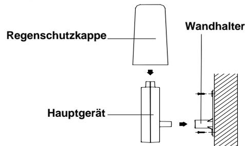
Als idealer Montageort für den Thermo-Hygro-Sensor empfiehlt sich z. B. eine Außenwand unter einem Dachvorsprung,
