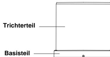
Für beste Ergebnisse sollte der Regensensor sicher auf einer waagerechten Oberfläche etwa 1 Meter über dem Erdboden so an einer freien Geländestelle montiert werden, dass keine
