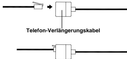
Stellen Sie bei der Kabelverlegung sicher, dass die Basisstation die Wetterdaten empfangen kann. Eine Erhöhung der Kabellängen kann auch zu einer Erhöhung der Störungen und damit zu Empfangsproblemen führen. Störungspegel sind in hohem Maße von den Umgebungsbedingungen abhängig. So kann z. B. die Verlegung auf oder nahe bei Metallflächen oder -rohren den Empfang deutlich verschlechtern
